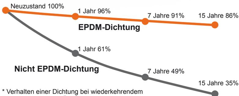
\* Verhalten einer Dichtung bei wiederkehrendem Zusammendrücken (Öffnen-Schließen des Fensters)
